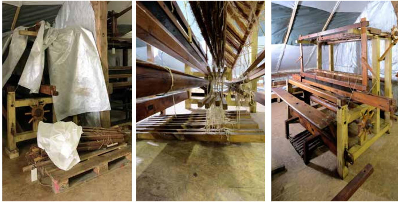
Webstuhl Nr. 9: Auffindesituation mit einem beigelagerten Konvolut an Tritten, Querhölzern und Schäften; Verschnürung und Umbau der Trittaufhängung nach vorne unter die Webbank, Einhängen der Schäfte, Korrektur des auflagernden Kettbaums. Fotos: Lucia Schwalenberg.
